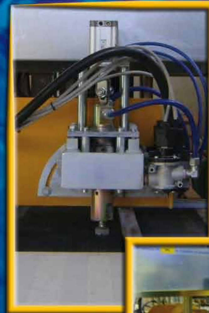
ALL-IN-ONE: rotobocciardatura e bocciardatura rotobushhammering and bushhammering Stocken mit Hammer und Stocken mit Drehplatte - abujardado con plato rodante y abujardado con martillo - otobouchardage et bouchardage avec marteau
